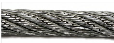
Flere trådbrud. Trådbrud er tegn på normalt slid på wiren. De opstår, når wiren bøjes om trisserne under belastning.
