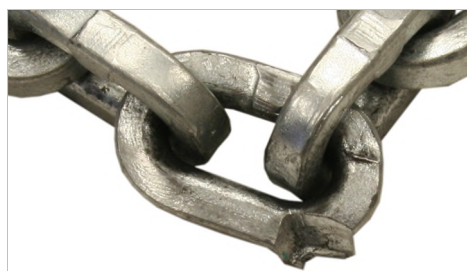
Kædeleddet er mekanisk beskadiget.
